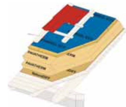
Einfacher ist die Dämmung von außen mit der Holzfaser Pavatherm. Hier wird auf der bestehenden Schalung die Dämmung verlegt. Vorteile: sehr gute Dämmung in Winter und Sommer, sowie hohen Schallschutz.
