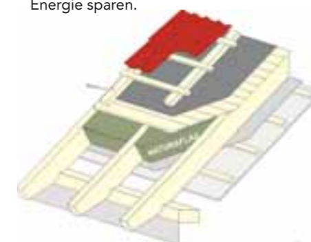
Die Holzweichfaser Pavaflex oder der 100% natürliche Flachsämmstoff sind die ideale Lösung für die Dämmung eines alten Daches von Innen ohne die Dachziegel zu entfernen.
