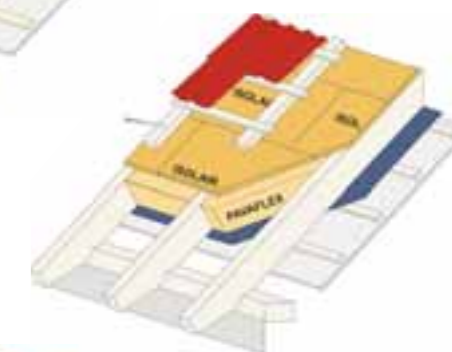
Die Holzweichfaser Pavaflex oder der 100% natürliche Flachsämmstoff sind die ideale Lösung für die Dämmung eines alten Daches von Innen ohne die Dachziegel zu entfernen.
