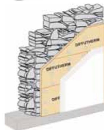
Außendämmung einer bestehenden Mauer Holzweichfaser Diffutherm, ideal für die Außendämmung. Auf dieser speziellen Holzweichfaser kann direkt verputzt werden.
