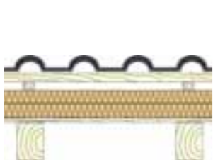
12 cm Holzfaser Pavatherm (140 kg/m 3 )
