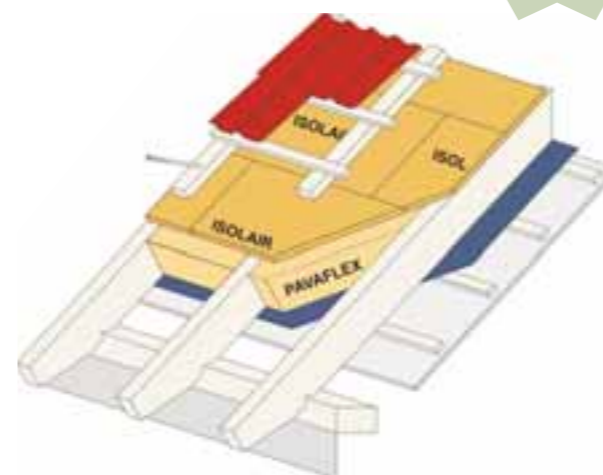
Dämmung des Daches mit natürlicher Holzfaser PAVATHERM
