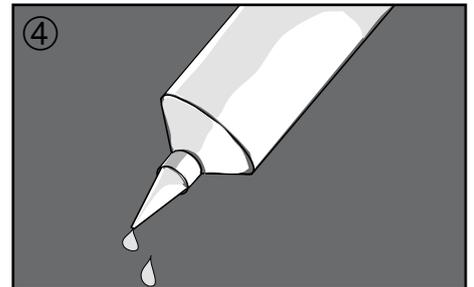
pegarse por encolado Stamcoll N55 o el pegamento Stamcoll AS. Agitar el pegamento en el bidón y llenar la botella de plástico. Extender el pegamento con el pincel, y presionar el conjunto. **Atención: no dejar secar la cola, debe aplicarse húmeda.** Consumo aproximado 40 g/metro lineal.
